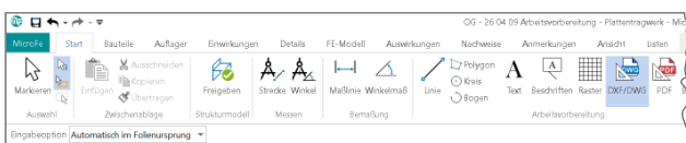
Bild 3. Eingabeoption „Automatisch im Folienursprung“
