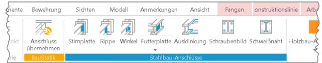
Für die Modellierung von Stahlbau-Anschlüssen stehen neue, aufgabenorientierte Bauteile wie Stirnplatten, Rippen oder Winkel zur Verfügung. Die Anschlussbauteile werden initial an die Abmessungen des Anschlussbauteils angepasst, sodass der Anschluss automatisch passt. Nachgewiesene Anschlüsse aus der BauStatik können alternativ direkt in das ViCADO-Modell übernommen werden. Die Verbindung zum Berechnungsmodell bleibt bestehen, sodass Änderungen jederzeit synchronisiert werden können.
