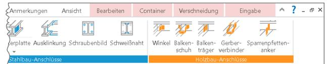
Auch im Holzbau lassen sich eine Vielzahl von Anschlüssen jetzt komfortabel in ViCADO modellieren. Stahlblechformteile wie Winkel, Balkenschuhe oder Gerberverbinder werden über die zugehörigen Schaltflächen gewählt und platziert. Zusätzlich können, wie bei den Stahlbau-Anschlüssen, nachgewiesene Verbindungen aus der BauStatik direkt übernommen werden – inklusive Ausnagelung und Verbindungsmitteln.
