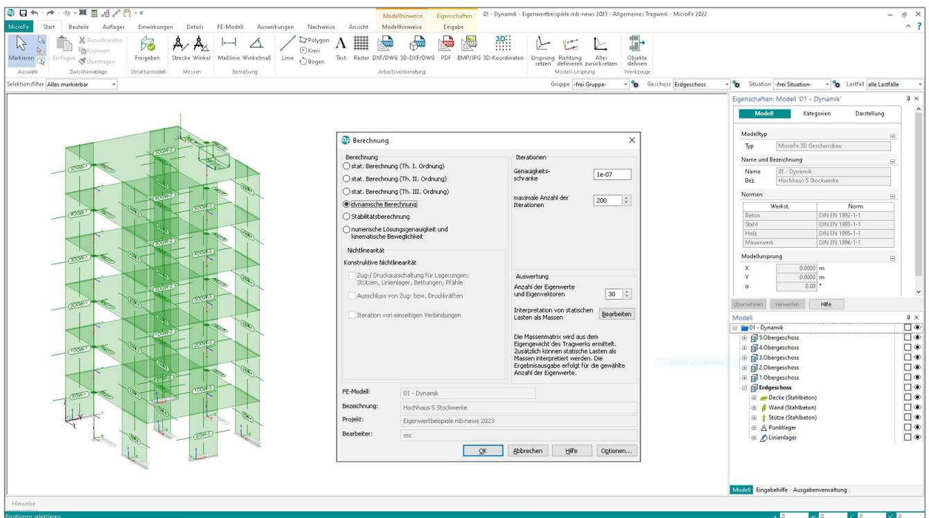
Bild 1. Vorbereitung einer Eigenwertberechnung in MicroFe
