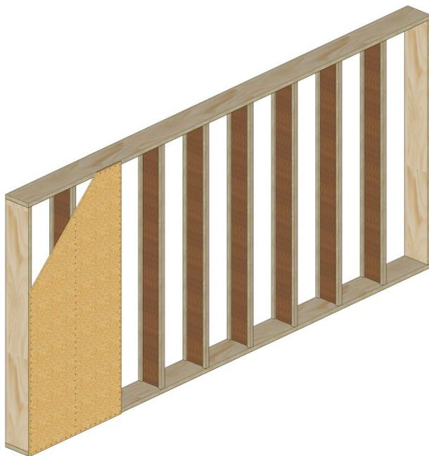
Bild 5. Häufig eingesetzter Wandquerschnitt mit Schwelle, Rähm und Randrippen aus STEICO LVL und Innenrippen aus STEICOWall
