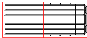
Bild 6. Bewehrungsanordnungen „nebeneinander“, „ineinander“ und „überlappend“
