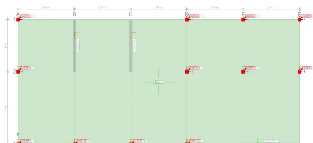
Bild 5. Stützen-Bauteile in der Draufsicht (z-Richtung)
