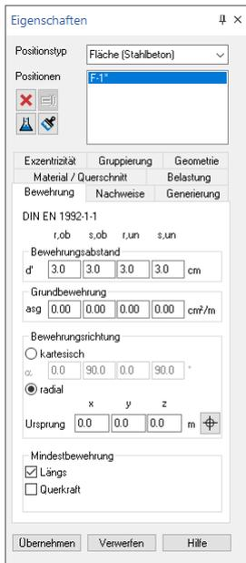
Bild 21. Radiale Bewehrungsrichtung
