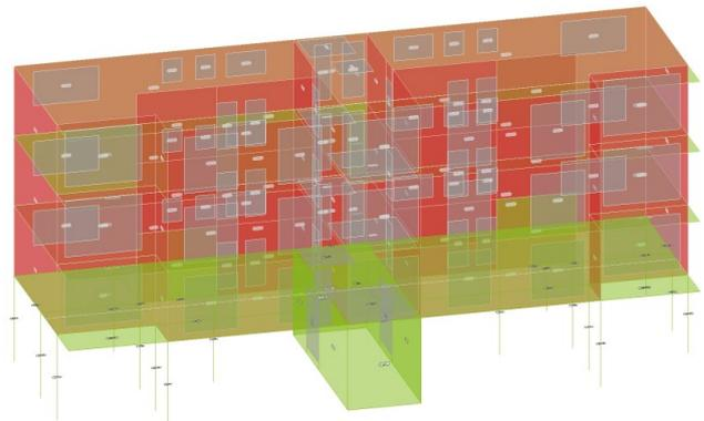
Bild 3. Strukturmodell des Tragwerks
