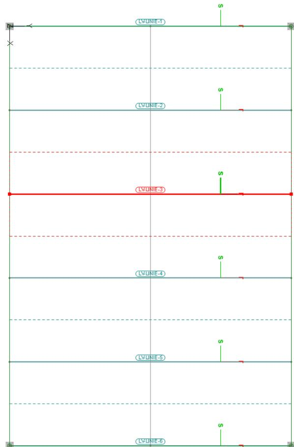
Bild 3. Markierte Lastverteilungslinie mit konstantem, rechteckigem Einflussbereich
