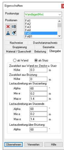
Dieses Vorgehen zur Behandlung der Stürze als Linienlager mit Sturzübergabe stellt eine ingenieurgemäße Vereinfachung dar, da dies die Steifigkeit der Linienlagerung für das mechanische FE-Modell nicht beeinflusst.
