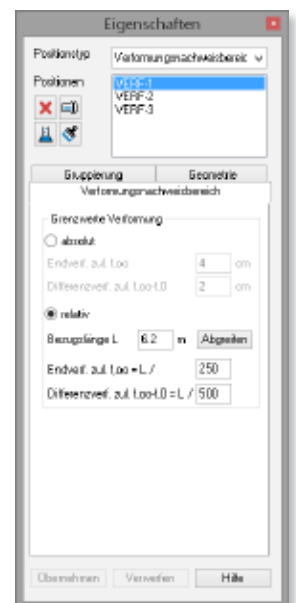
Bild 7. Definition von Verformungsnachweisbereichen
