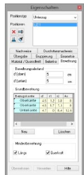
Bild 9. Definition der Grundbewehrung für einen Unterzug
