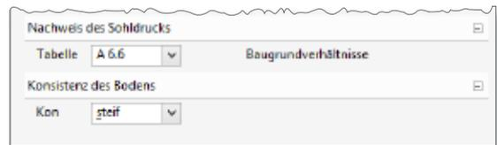
Bild 4. Auswahl der Tabelle für bindigen Boden nach DIN 1054 zum Nachweis des ausreichenden Sohlwiderstandes im Modul S500.de
