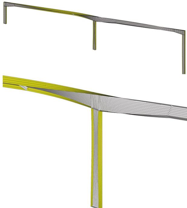
Bild 12. a) Erste Biegedrillknickfigur
