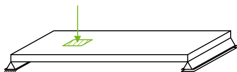
Bild 3. Beispiel für eine Rechtecklast
