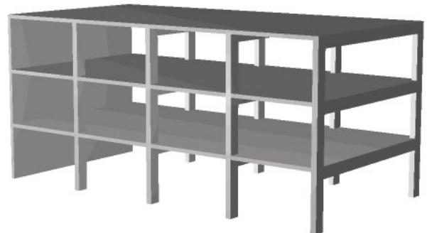
Bild 6. Weiches Aussteifungssystem mit Rahmen
