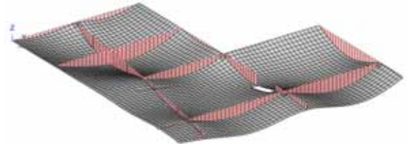
Verformung als „farbige Flächendarstellung“ mit Auswertungslinien ohne Wertdarstellungen
