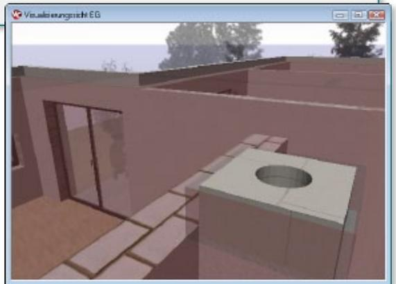
Die automatisch erzeugte Deckenöffnung passt sich der Größe des Schornsteins und dem gewählten Abstand zum Schornstein an. Die Deckenöffnung kann darüber hinaus mit den Werkzeugen zur Geometriemanipulation weiter angepasst werden. Wurde eine Deckenöffnung manipuliert, erfolgt keine weitere automatische Anpassung der Öffnung, wenn die Schornsteingeometrie geändert wird. Soll eine automatische Anpassung in der weiteren Projektbearbeitung erneut folgen, kann dies optional gewählt werden.
