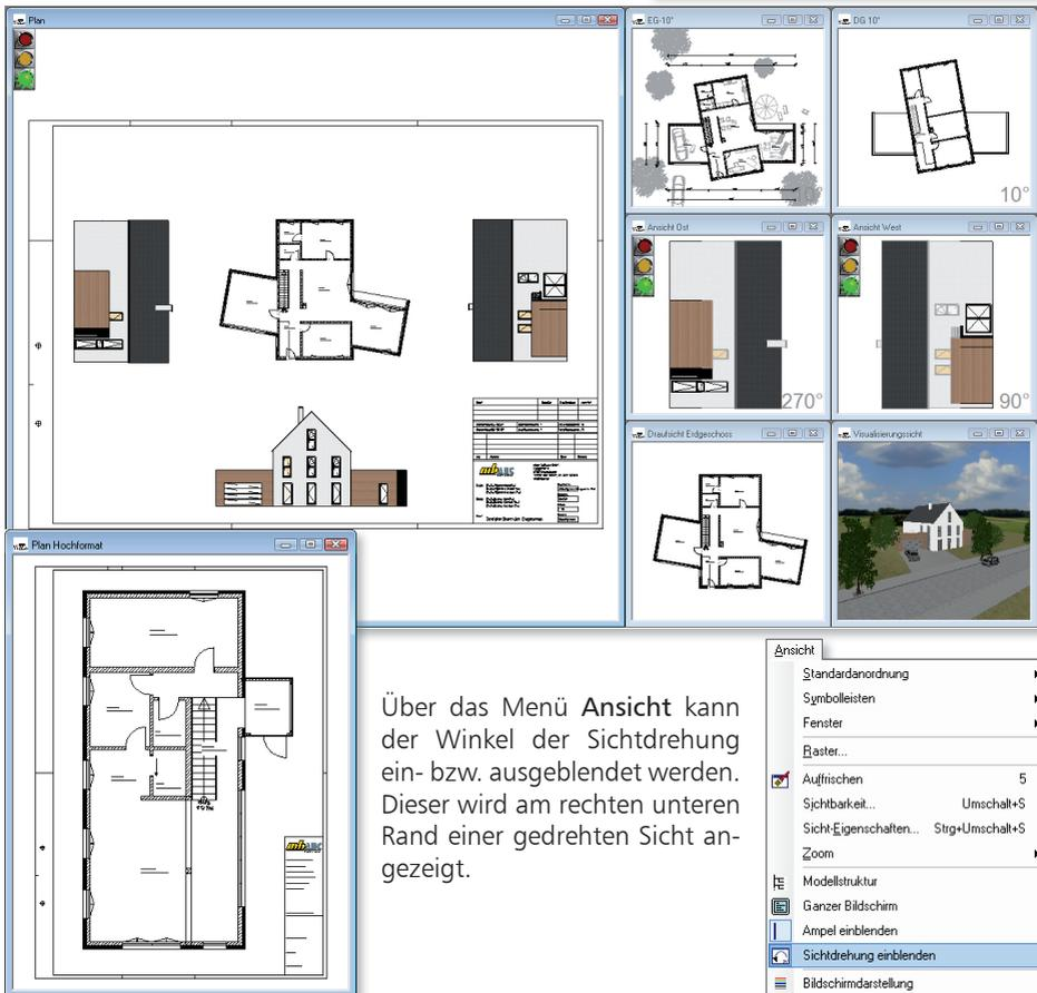
Über das Menü **Ansicht** kann der Winkel der Sichtdrehung ein- bzw. ausgeblendet werden. Dieser wird am rechten unteren Rand einer gedrehten Sicht angezeigt.
