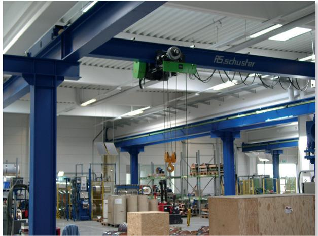
Einträger-Brückenlaufkran mit Unterflansch-Laufkatze als Hallenkran
