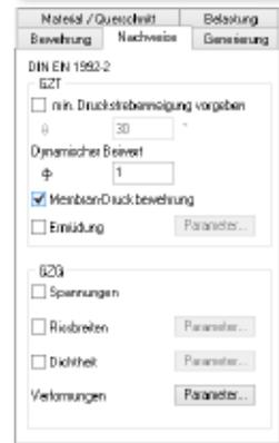
In folgendem Beispiel treten im linken Wandsystem im Erdgeschoss zwei Knoten mit Druckspannungsüberschreitung auf. Im rechten Wandsystem wurde die Membran-Druckbewehrung aktiviert, so dass an diesen Knoten die kritischen Druckspannungen durch Bewehrung aufgenommen werden.
