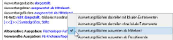
Zudem kann mit der Option **auswerten als Resultierende** sowohl für die Auswertungslinie als auch für die Auswertungsfläche das Integral der Ergebniswerte innerhalb der jeweiligen Position ermittelt werden.
