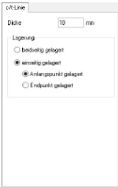
Die Länge der c/t-Linien-Position definiert die Länge *c* der c/t-Linie, die Dicke *t* des betreffenden Querschnittsteils ist als Positionseigenschaft vorzugeben. Neben den Abmessungen des jeweiligen Querschnittsteils ist außerdem zu definieren, ob der betreffende Querschnittsteil beidseitig oder nur einseitig gelagert ist.
