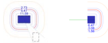
Erforderliche Durchstanzbewehrung je Rundschnitt an Rechteckstütze
