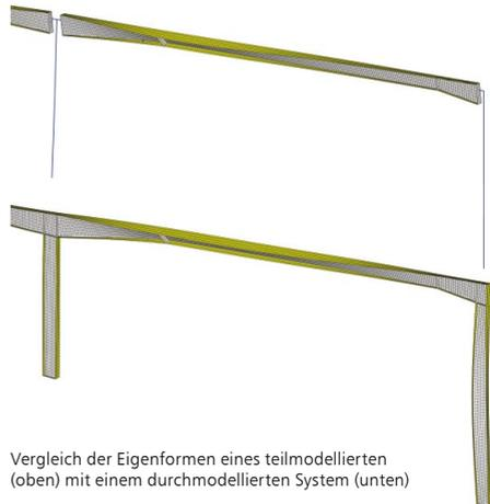
Vergleich der Eigenformen eines teilmodellierten (oben) mit einem durchmodellierten System (unten)
