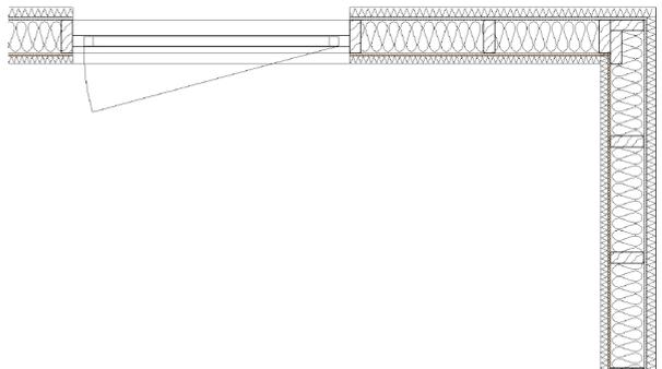
Mit der mb WorkSuite 2023 bringt ViCADo mit dem neuen Bauteil „Holz-Ständerwand“ ein Werkzeug zur Planung von Tragwerken in Holz-Ständerbauweise mit. Dank des mehrschaligen Aufbaus und der bauteilorientierten Gestaltung der Rahmenkonstruktion ermöglicht dies eine detaillierte Planung, Darstellung und Auswertung des Wandaufbaus.
