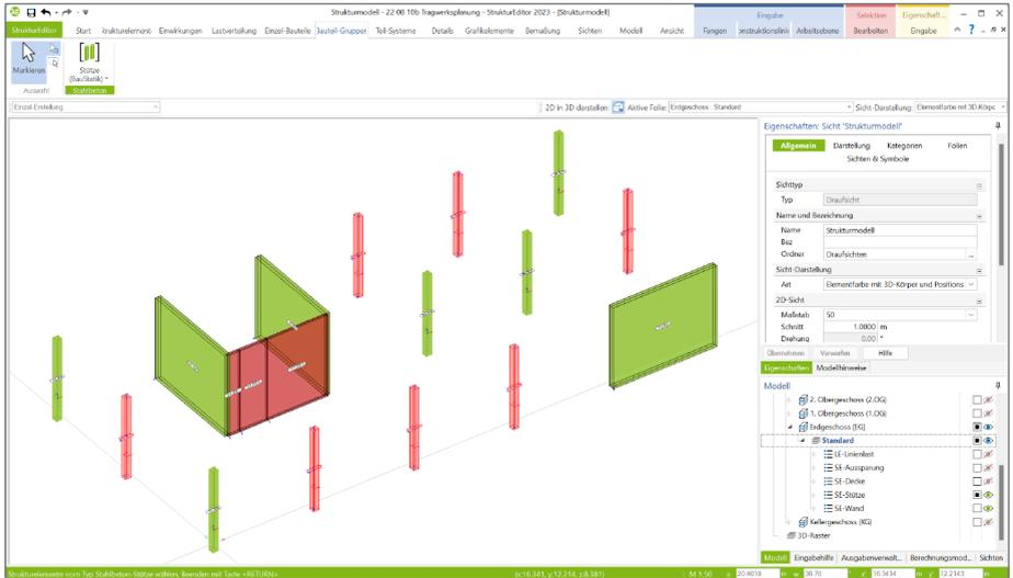
Nach der Bestätigung ermöglicht der Dialog „Berechnungsmodell erstellen“ die Vorgabe eines Namens und einer Bezeichnung. Darüber hinaus ermöglicht das Kapitel „Lastabtrag“ die Auswahl der Lastquelle für das Berechnungsmodell Bauteil-Gruppe. Hier können die Berechnungsmodelle zur Verteilung der vertikalen Belastungen sowie MicroFe-Bemessungsmodelle (2D- und 3D-Modelle) ausgewählt werden. Jedes Stützen-Strukturelement erhält somit seine durch die Berechnung zugewiesene Belastung.
