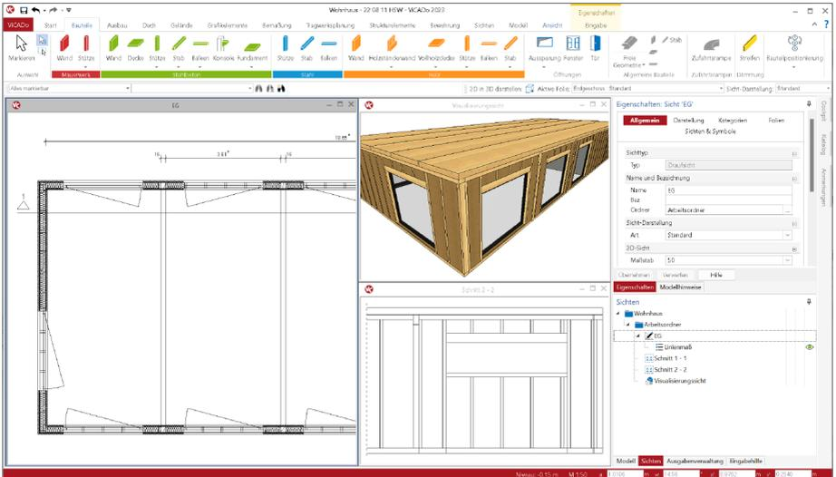
Der in ViCADo bekannte mehrschalige Wandaufbau ist eine ideale Grundlage für die Planung von Holz-Ständerwänden. Der neue Schicht-Typ „Rahmenkonstruktion“ bietet die Möglichkeit, die für die Holzständerwand typische Konstruktion aus vertikalen und horizontalen Hölzern zu erzeugen.
