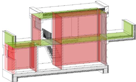
Die Erfahrung zeigt, dass kleinere geometrische Abweichungen, wie z.B. verspringende Wandachsen, verschmiert werden sollten. Für alle Bauteile, die im Architekturmodell als „tragend“ definiert wurden, werden in ViCADO.ing Strukturelemente erzeugt. ViCADO bietet zur Idealisierung und Vereinfachung sowohl spezielle automatisierte als auch manuelle Strategien an.
