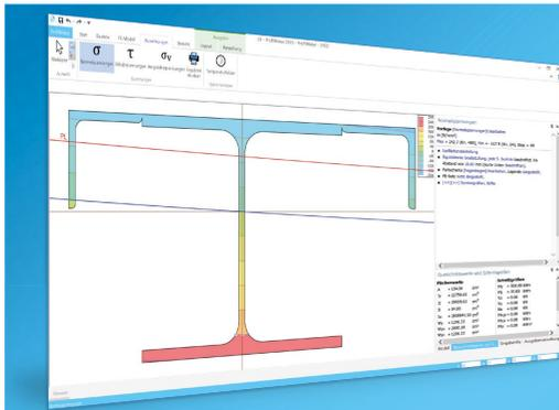
Der mb-ProfilMaker ist für die Bearbeitung von selbst definierten Profilquerschnitten konzipiert. Unterstützt werden Vollquerschnitte und dünn- und dickwandige Profile. Diese werden aus Normprofilen, deren Teilquerschnitten oder geometrischen Formen frei zusammengesetzt. Direkt im ProfilMaker (P100.de) können Querschnittswerte und Spannungen aus beliebiger Beanspruchung ermittelt werden. Innerhalb der mb WorkSuite sind die definierten Profile in ViCADO, BauStatik, MicroFe und EuroSta verwendbar.
