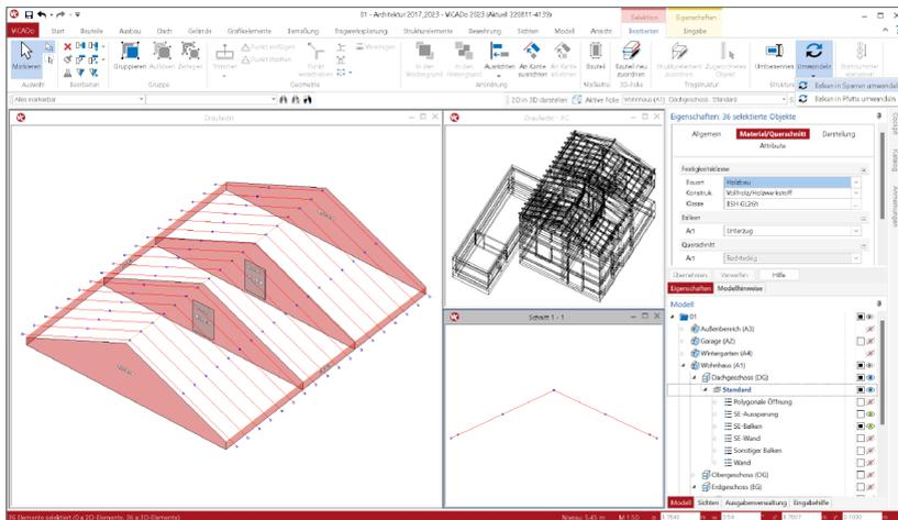
Anders hingegen ist die Situation bei Architekturmodellen, die aus dem IFC-Format importiert wurden. Je nach Art der Modellierung und den Möglichkeiten des CAD-Systems werden z.B. Sparrenbauteile aus Balken modelliert. Nach dem Import in ViCAdo.ing kann die Situation entstehen, dass Sparrenbauteile durch die Ableitung des Strukturmodells mit Elementen des Typs „SE-Balken“ repräsentiert werden.
