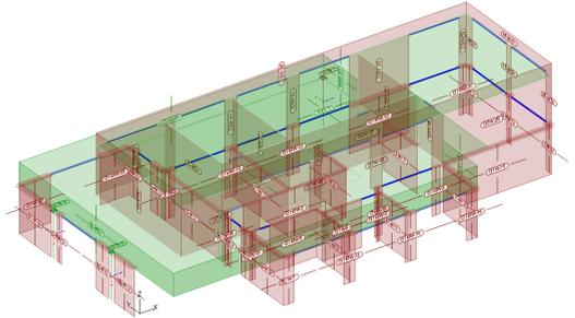
Im Rahmen der Bauteilbemessung können die Eigenschaften der Bauteile, wie z.B. die Querschnittsabmessungen, verändert werden. Damit am Ende der Projektbearbeitung ein Bauteil in allen Verwendungen die gleichen Eigenschaften aufweist, hilft das Fenster „Modellhinweise“ in den Anwendungen der mb WorkSuite.
