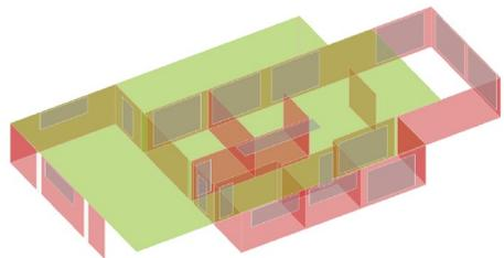
Im StrukturEditor können Berechnungsmodelle für die Verteilung von vertikalen und horizontalen Lasten, sowie für die Bauteilbemessung als Einzel-Bauteil oder Teil-System, erzeugt werden.
