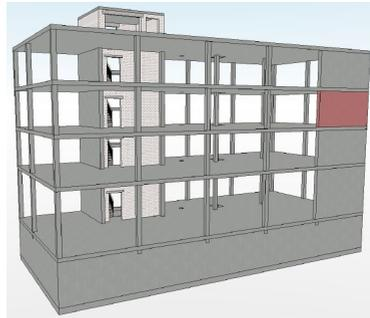
Gehört zum Leistungsumfang der Projektbearbeitung auch die Ausführungsplanung, also z.B. die Erstellung von Bewehrungsplänen, wird das virtuelle Gebäudemodell auch für diesen Arbeitsschritt eingesetzt und die Bauteile bewehrt. Auch die Positionspläne für das Statik-Dokument werden auf Grundlage des Architekturmodells erzeugt.
