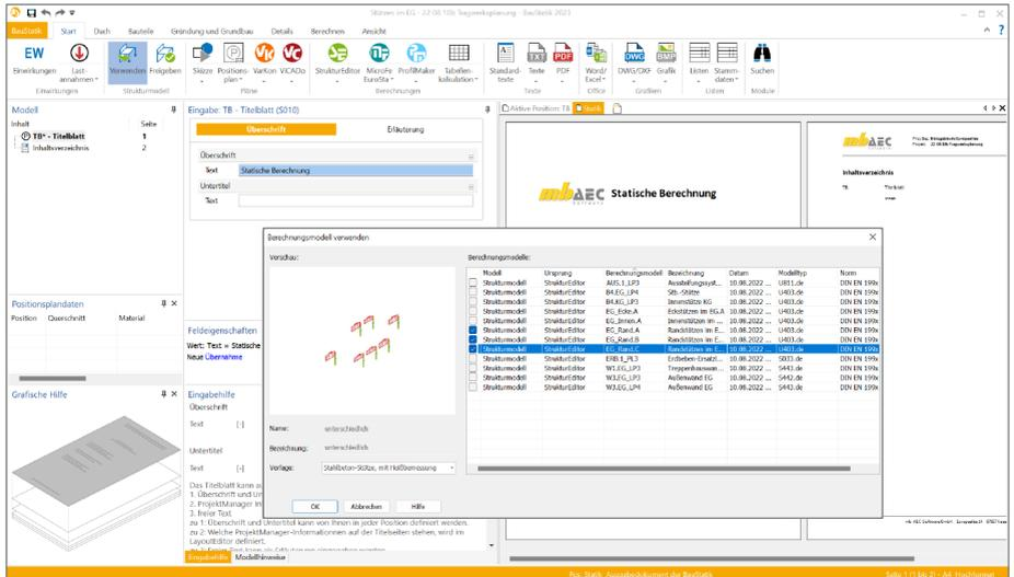
Im Zuge der Bemessung in den Bemessungsmodellen (Positionen) der BauStatik kann die Zuordnung der Strukturelemente des Berechnungsmodells „Bauteil-Gruppe“ zu Laststufen bzw. zu Bemessungsmodellen eingesehen und auch verändert werden.
