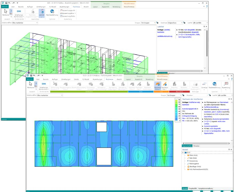
Die positionsorientierte, grafische Eingabe von Bauteilen ermöglicht eine praxisbezogene und ingenieurmäßige Tragwerksplanung. Die Umsetzung in das abstrakte, mathematische FE-Modell erfolgt in MicroFe automatisch. Dadurch ist sichergestellt, dass überall dort FE-Knoten vorhanden sind, wo sie für die Berechnung benötigt werden. Dies erleichtert und beschleunigt deutlich die Modellierung des Tragwerks.
