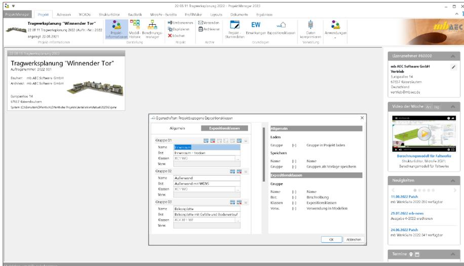
Die Abbildung zeigt, dass für jedes neue Projekt fünf Gruppen von Expositionsflächen angeboten werden. Diese umfassen typische Konstellationen von Expositionsflächen für Bauteile in „Innenräumen“, für „Außenwände“, für „Balkonplatten“, für „Gründungsbauteile“ sowie für „Parkdecks“.
