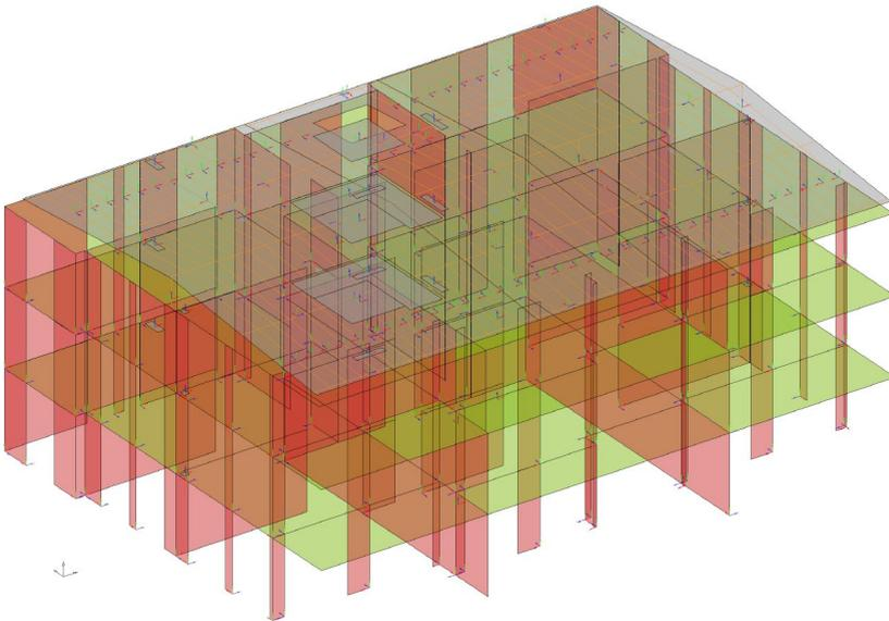
Für den Tragwerksplaner bietet es sich an, nicht nur die Geometrie der Strukturelemente zu idealisieren, sondern auch die Namen der Strukturelemente zu systematisieren. Aus dieser geometrischen Grundlage heraus werden Teilmengen, die Berechnungsmodelle, bestimmt, die für die Nachweisführung und Bemessung von einzelnen Bauteilen oder Gebäudeteilen benötigt werden.
