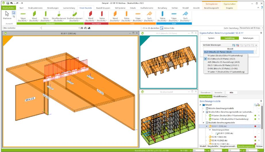
Im Rahmen dieser modifizierten FE-Berechnung werden alle Unterzüge des als Lastquelle gewählten Bemessungs- oder Lastverteilungsmodells mechanisch als Linienlager simuliert. Die Belastungen aus der FE-Berechnung werden zu Blocklasten mit konstanter Lastordinate umgewandelt und für die Bemessung in der BauStatik vorbereitet. Bei der Auswahl eines Bemessungsmodells als Lastquelle, kann die Abstufung der Blocklasten manuell gesteuert werden.
