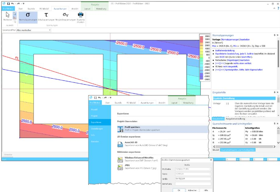
Wie die Profile werden auch Materialkennwerte in den Projekt-Stammdaten verwaltet. Für die Berechnungen und Analysen mit dem ProfilMaker wird auf die Materialkennwerte nach EC 3 bzw. 9 zugegriffen. Die voreingestellten Tabellen können durch Einfügen zusätzlicher Zeilen um weitere Materialeigenschaften ergänzt werden. Einmal eingetragen steht dieses „individualisierte“ Material in der kompletten WorkSuite im aktuellen Projekt bereit.
