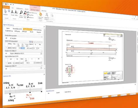
Mit VarKon-Modulen werden Schal- und Bewehrungspläne für Bauteile automatisiert erzeugt. Das Erzeugen der Pläne erfolgt allerdings nicht über eine grafische Konstruktion, sondern über die Eingabe der entsprechenden Parameter in einer speziell hierfür vorbereiteten Benutzeroberfläche. Dies ermöglicht eine schnelle Generierung von Bewehrungsplänen ohne lange Einarbeitungszeit.
