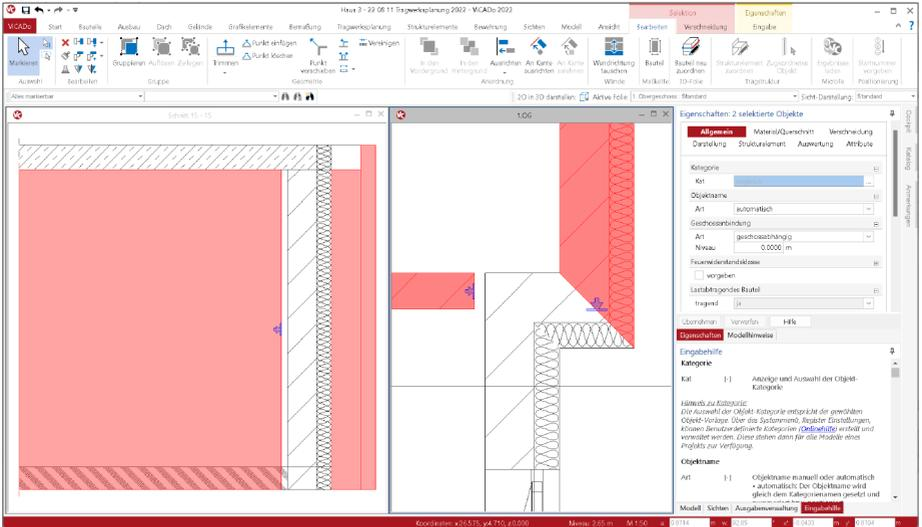
Ein Wandende, das mit einer anderen Wand verschritten ist, kann nun von der anderen Wand direkt gelöst werden, ohne dass die Verschneidung vorher angepasst werden muss. Auch die Längenänderung mehrschaliger Wände kann nun in einem Schritt durchgeführt werden. Es ist hervorzuheben, dass Änderungen am Bauteil, die durch manuelles Trimmen entstehen (z.B. einer einzelnen Wandschicht), erhalten bleiben, sofern dies geometrisch möglich ist.
