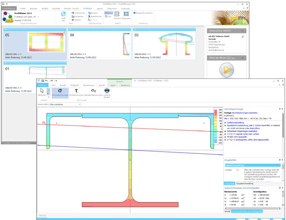
Neue Querschnitte können mit Profilen aus den mb-Stammdaten beliebig zusammengesetzt werden. Außerdem können geometrische Grundformen und polygonale Konturen für dünnwandige Bereiche verwendet werden. Die Profile können sowohl aus dünnwandigen als auch aus fülligen Bereichen bestehen.
