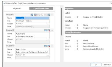
Die Dokumentation der Expositionsclassen erfolgt im Zuge der Ausgaben der Stahlbeton-Bemessung. In der Ausgabe erfolgt die seitenbezogene Definition, gefolgt von den daraus abgeleiteten Betonüberdeckungen. Falls die Anforderungen an die Betonfestigkeit nicht erfüllt sind, wird auch in der Ausgabe auf diese Situationen hingewiesen.
