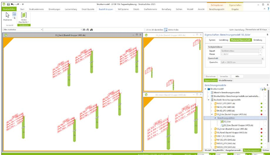
Über die Auswahl des gewünschten Zielwertes, wie z. B. die maximale vertikale Stützenbelastung, bestimmt der StrukturEditor das maßgebende Stützen-Bauteil und bietet dies der BauStatik zur stellvertretenden Bemessung an. Im Zuge der Dokumentation über das BauStatik-Modul „S008 Strukturmodell einfügen“ erfolgt eine gut nachvollziehbare Dokumentation der Berechnungsmodelle „Bauteil-Gruppe“.
