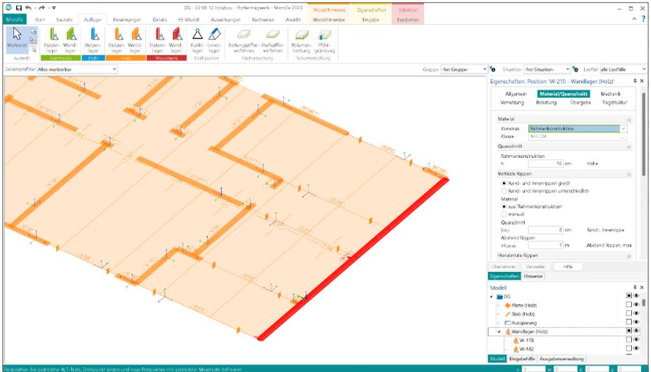
Für das bauteilbezogene „Wandlager aus Holz“ kann in MicroFe 2023 die Variante „Rahmenkonstruktion“ ausgewählt werden. Alle notwendigen Informationen zur Ermittlung der Lagersteifigkeiten werden abgefragt. Somit stehen auch für den Holzbau aus Holz-Ständerwänden immer realistische Steifigkeitswerte für die Berechnung zur Verfügung.
