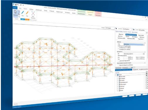
EuroSta dient der Berechnung und Bemessung von ebenen und räumlichen Stabtragwerken aus Holz oder Stahl. Es bietet eine effektive, grafische Bearbeitung der Tragstruktur durch die Integration von Eingabe, Statik, Nachweisen und Bemessung – einschließlich Systemknickstabilität, Eigenschwingungen und Numerik/Kinematik-Tests bis hin zur Anschlussbemessung.
