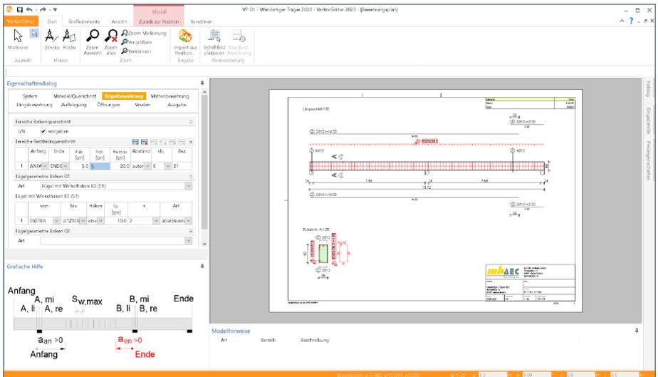
Das Erzeugen der Pläne erfolgt nicht auf dem Weg der grafischen Konstruktion, sondern über die Eingabe der entsprechenden Parameter in einer speziell hierfür vorbereiteten Benutzeroberfläche. So erlauben die VarKon-Module eine schnelle Generierung von Bewehrungsplänen ohne lange Einarbeitungszeit.
