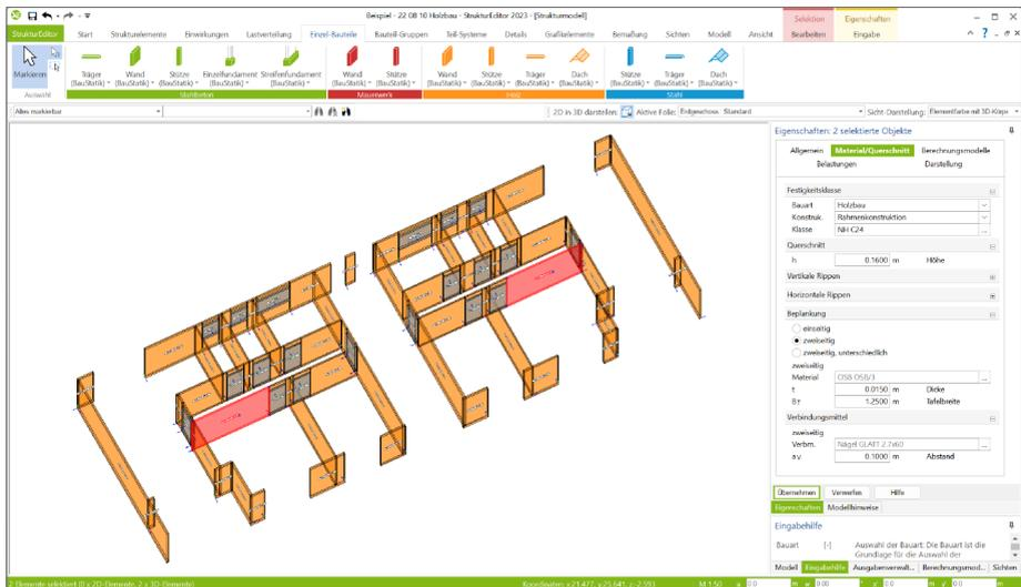
Herzstück des neuen Berechnungsmodells ist die Abbildung einer Holz-Ständerwand im Strukturelement „SE-Wand“. Mit dem Wechsel in den Element-Eigenschaften auf „Rahmenkonstruktion“ können alle nachweis- und steifigkeitsrelevanten Eingaben zu den vertikalen und horizontalen Rippen, zur ein- oder zweiseitigen Beklankung sowie zu den Verbindungsmitteln gesteuert werden.
