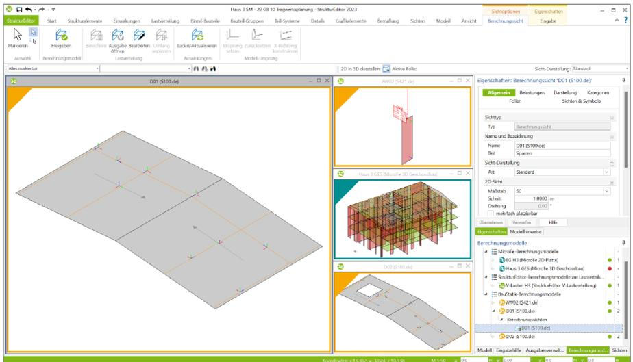
Die Berechnungsmodelle werden zielorientiert für das gewünschte Bemessungsmodul erstellt. Somit ist der StrukturEditor in der Lage, die vorliegenden Belastungen passend für die Nachweisführung und Bemessung vorzubereiten.
