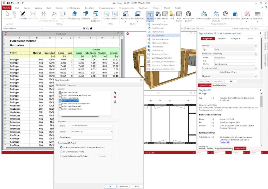
Für eine schnelle Auswertung der Holzbauteile bietet ViCAdo die Bauteil-Listensicht „Holzelemente“ an. Hier können dank der gut vorbereiteten Vorlagen direkt praxisgerechte Listen erzeugt werden. Die Listensichten werden automatisch auf Holzbauteile eingegrenzt und können vom Umfang auf Ebene der Modellstruktur oder der Bauteil-Kategorien weiter gesteuert werden.
