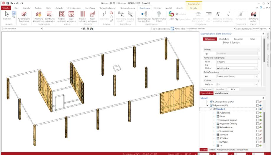
Dank der automatischen Übernahme wird ein noch größerer Zeitvorteil bei der Übernahme der Bewehrung erreicht. Mit der Option „Bewehrung einblenden“, aus dem Register „Bewehrung“, werden alle Bewehrungsverlegungen, die durch Bemessungen erzeugt wurden, an der korrekten Stelle im Architekturmodell in ViCADo.ing angezeigt. In der Folge wird mit einem Klick die jeweils gewünschte Bewehrung in das Modell übernommen und kann in ViCADo.ing weiterbearbeitet werden.
