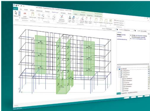
MicroFe – eines der ersten FEM-Systeme für die Tragwerksplanung – dient der Analyse und Bemessung ebener und räumlicher Stab- und Flächen-tragwerke. Es ist modular aufgebaut und zeichnet sich durch eine konsequent positionsorientierte Arbeitsweise aus. Spezielle Eingabemodi machen die Bearbeitung verschiedenster Tragsysteme (Platte, Scheibe, 3D-Faltwerk, Rotationskörper und Geschossbauten) besonders komfortabel.
