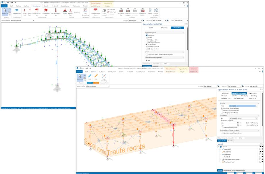
Die positionsorientierte Eingabe der Stäbe ermöglicht eine praxisbezogene und ingenieurmäßige Tragwerksplanung, wobei sich das zu berechnende Modell aus Positionen wie z.B. Riegel, Gurte und Streben zusammensetzt. EuroSta.stahl setzt diese Eingaben automatisch in ein abstraktes, mathematisches FE-Modell aus FE-Elementen, FE-Knoten usw. um. Dadurch ist sichergestellt, dass die FE-Knoten überall dort erzeugt werden, wo sie für die Berechnung benötigt werden.
