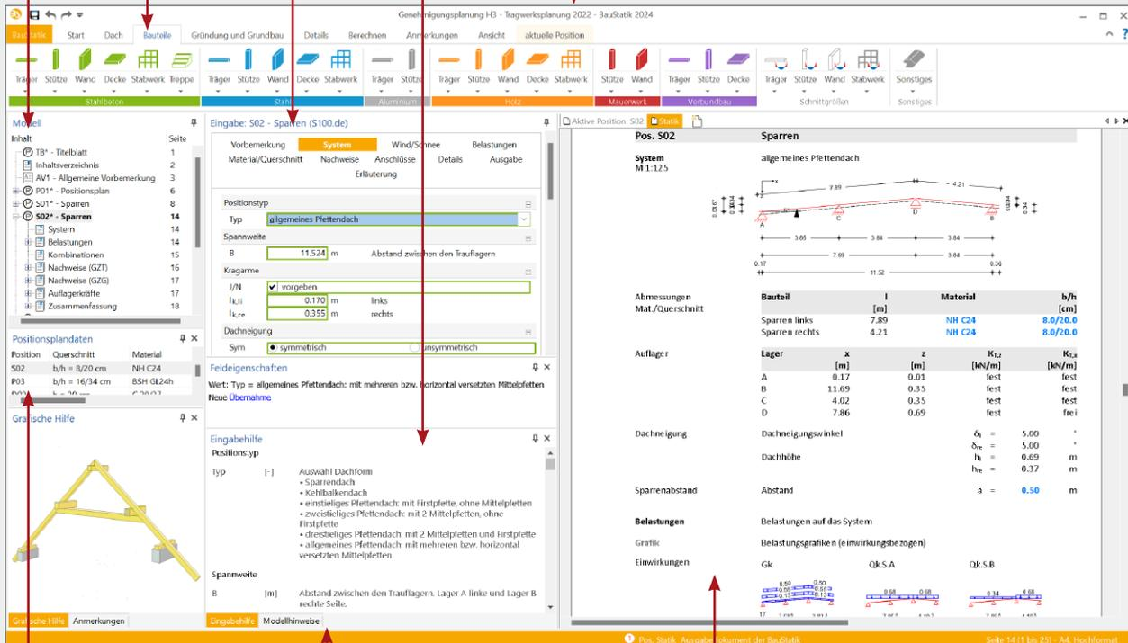
Mit jeder Berechnung werden Positionsplandaten erzeugt, z.B. Material, Ausnutzung und Querschnittsabmessungen.
