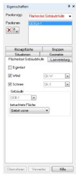
Bild 10. Positionseigenschaften Flächenlast Gebäudehülle
