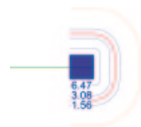
Erforderliche Durchstanzbewehrung je Rundschnitt an Wandende
